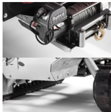
TP Vinsch kan användas när flishuggen ska upp eller ner för backar. Marknadens största frihöjd: 200 mm Variabel larvbandsbredd: 1 150–1 300 mm Förstärkt skydd av hydraulikslangar.
