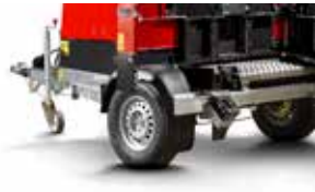
Trinbræt på en-akslet trailer med højdejusterbar trækstang
