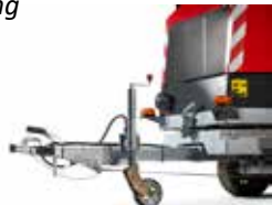
Højdejusterbar trækstang - i lav position
