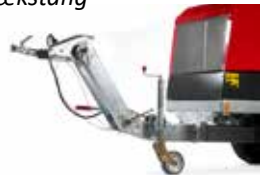
En-akslet trailer med fast trækstang
