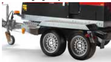
To-akslet trailer med fast træks- tang og drejkrans
