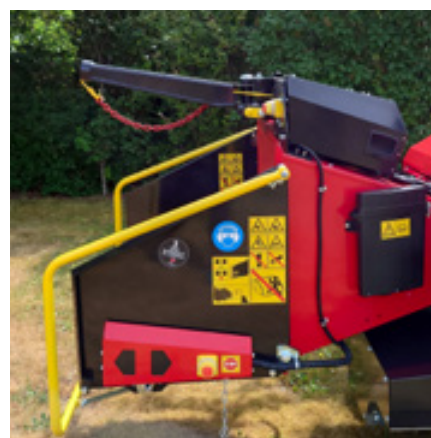
Hydraulisk spil kan tilvælge alle TP 215 Mobil og Track modeller
