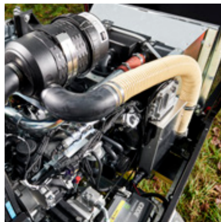
Hatz 4H50 Stage V motor med 55 kW
