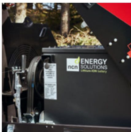
Kraftig 44 kWh batteri
