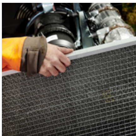
Motorfilter – rask og enkel rengjøring
