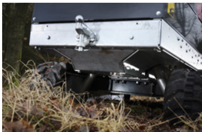
Største frihøyde på markedet: 250 mm, enkel service og robust slangebeskyttelse. Variabel beltebredde.
