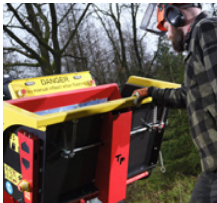
Enkel håndtering av den forsterkede kraftige trekten takket være gassfjæren
