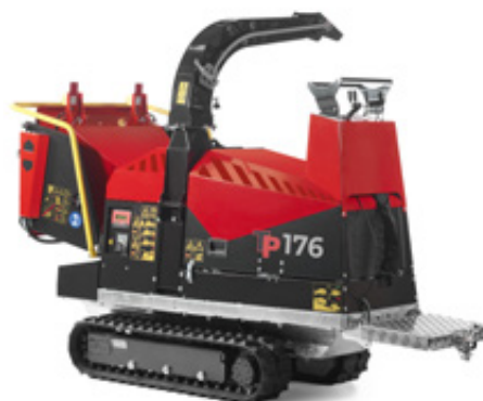
Manuel betjening og plattform med sikkerhetsafbryder
