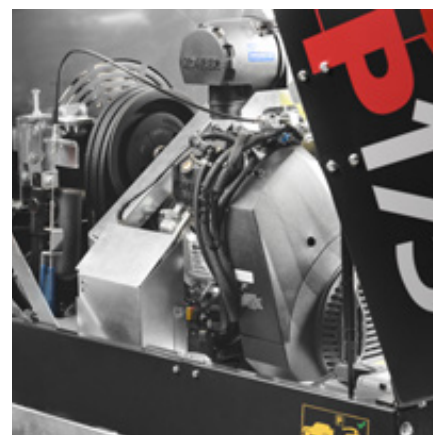
Sterk Kohler EFI-motor med 38 hk
