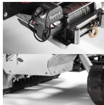
TP Spil kan anvendes, når flishuggeren skal op eller ned af skrånninger. Største frihøjde på markedet: 200 mm. Variabel bæltevidde: 1150-1300 mm. Forstærket beskyttelse af hydraulikslanger.
